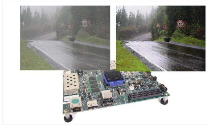
FPGA 原型板上运行的去雾算法。
